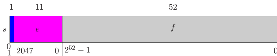
Abbildung 1.3.: Aufteilung der 8 Bytes einer real*8 Fließkommazahl in ein Vorzeichen-Bit s , 11 Exponent-Bits e , und 52 Mantissen-Bits f . Die untere Zeile gibt den Wertebereich an, den s , e und f annehmen können.
