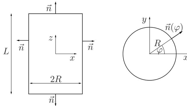
Abbildung 1: Längs- und Querschnitt des Zylinders
