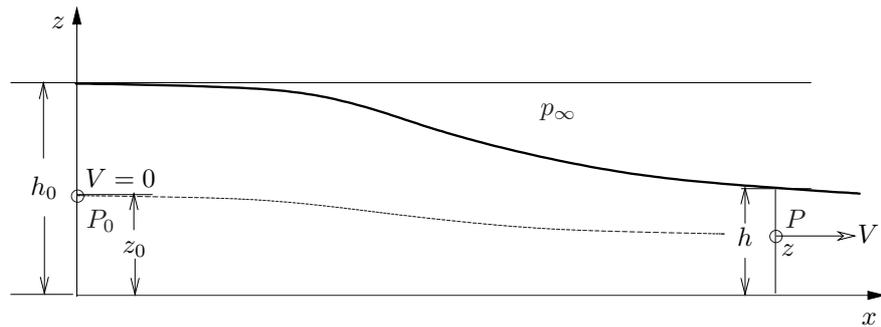
Abbildung 2: Definition der verwendeten Größen.
