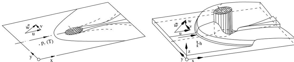
Abbildung 1: Vergleich zwischen ebener, kompressibler Gasströmung (links) und Flachwasserkanal (rechts). (Quelle: Seminar in Flugantriebe, Karl Wörrelein, Fachgebiet Gasturbinen und Flugantriebe, TU Darmstadt, 2. Auflage)
