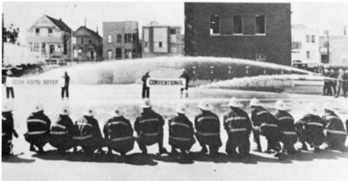
Erhöhung der Wurfweite von Freistrahlen durch Zusatz von Additiva. (Abb. 1.3 aus SCHOWALTER.)
