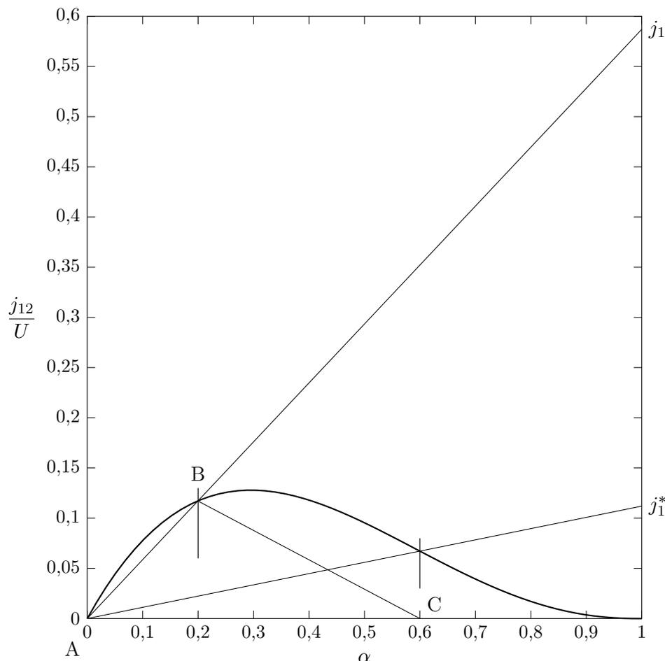
Driftfluss-Relation von Richardson und Zaki,  $j_{12}/U = \alpha(1 - \alpha)^{2,39}$ . (Dünne Linien: Lösung.)
