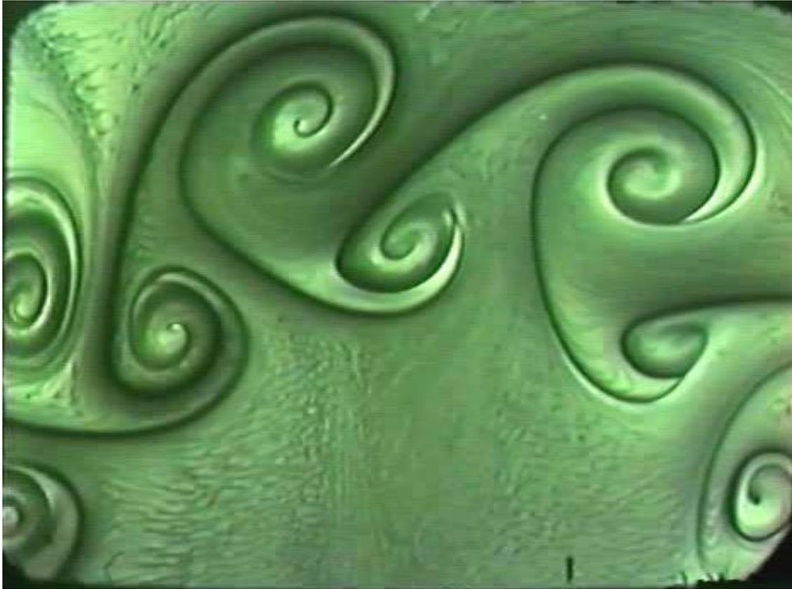
**Figure 1.2.:** Instabilität der Strömung hinter einem Zylinder (nach Mollo-Christensen 1968).
