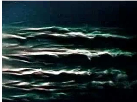
**Figure 1.16.:** Dynamik eines turbulenten Fleckens in einer Plattengrenzschicht nach [Homsy et al. 2000](#).
